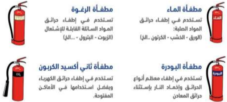
شكل 1: يوضح أنواع طفايات الحريق واستخداماتها
